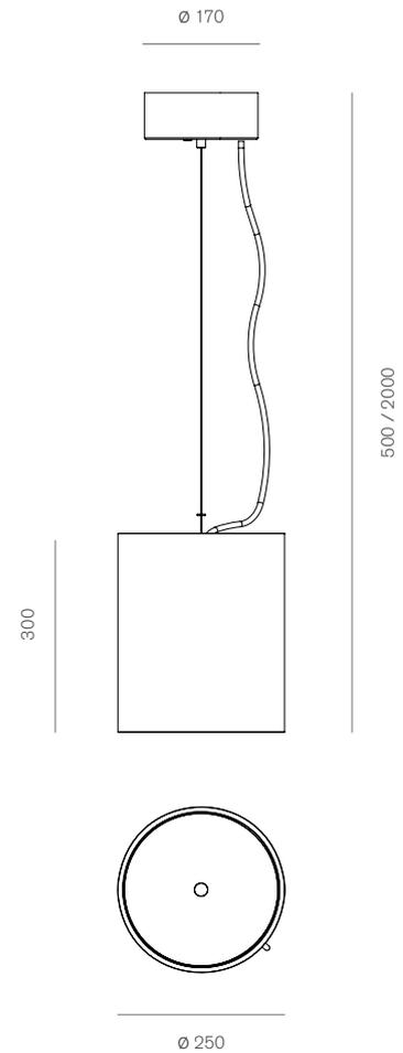
La semplicità di questo apparecchio diventa originalità e novità. Il cilindro di metallo contiene e indirizza la luce proveniente da due schede LED al suo interno, rendendola un vero e proprio proiettore di luce bidirezionale.
