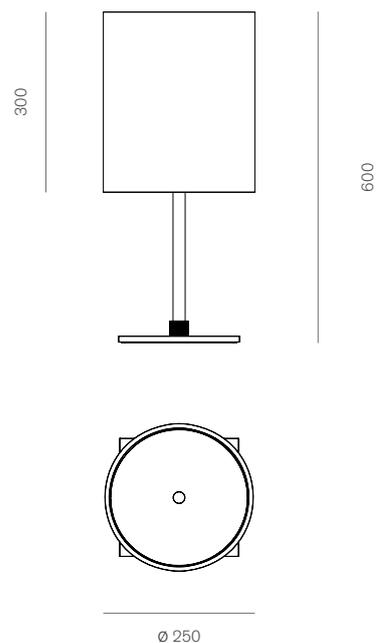
La semplicità di questo apparecchio diventa originalità e novità. Il cilindro di metallo contiene e indirizza la luce proveniente da due schede LED al suo interno, rendendola un vero e proprio proiettore di luce bidirezionale.
