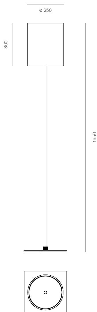
La semplicità di questo apparecchio diventa originalità e novità. Il cilindro di metallo contiene e indirizza la luce proveniente da due schede LED al suo interno, rendendola un vero e proprio proiettore di luce bidirezionale.
