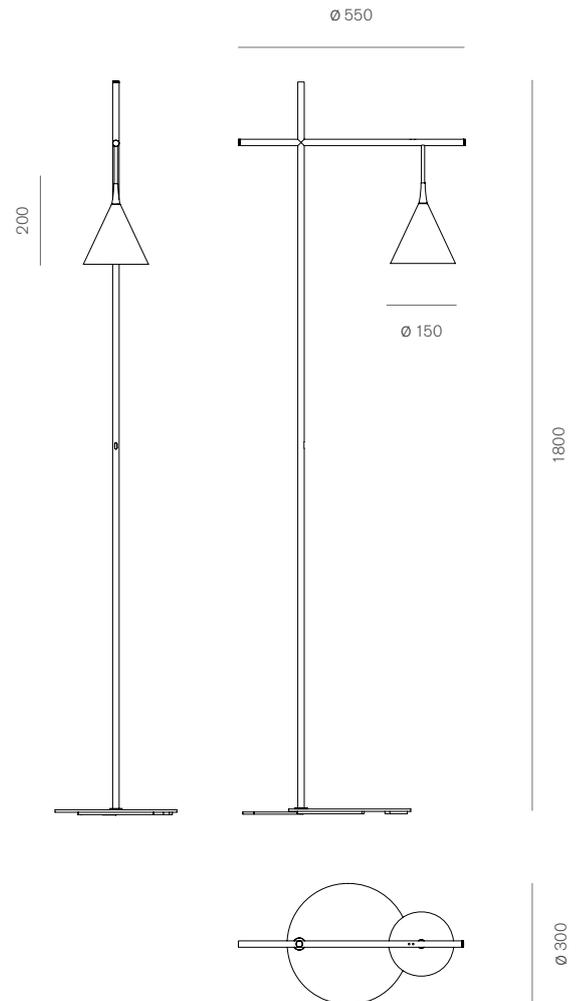
Sistema composto dalle versioni da terra, lettura, sospensione, parete e composizioni. Tutte le versioni sono dotate di schede LED regolabili con 4 livelli di emissione e quantità di luce. Le versioni da terra e da lettura hanno i regolatori incorporati nello stelo, le versioni da sospensione e da parete necessitano per la loro regolazione, della installazione di dimmer a parete. Su richiesta per la versione a sospensione è possibile realizzare delle composizioni a più elementi.
